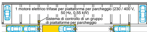
In loco: interruttore principale con possibilità di chiusura a 180 cm d'altezza. Un pannello di comando per ogni piattaforma per parcheggio. Luce lampeggiante.
